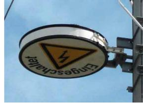
Abbildung 11c und 11d: Schaltzeiger „Oberleitung des Ladegleises ist ausgeschaltet“
